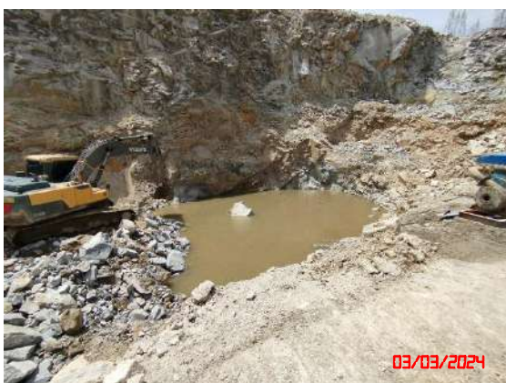
รูปที่ 19 บ่อรับน้ำชุมเหมือง
